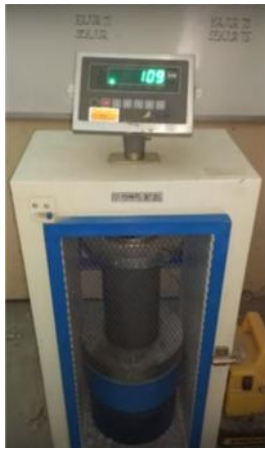
Gambar 4. Uji kuat tekan beton umur 1 hari
