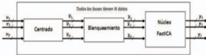
Figura 1. Etapas del algoritmo FastICA. Las dos primeras etapas - centrado y blanqueo - son en realidad operaciones de pre procesamiento que optimizan el subsiguiente algoritmo de ICA.
