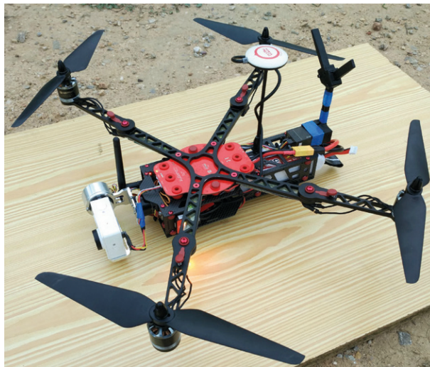
Figura 13. Armazón o estructura tipo X.
