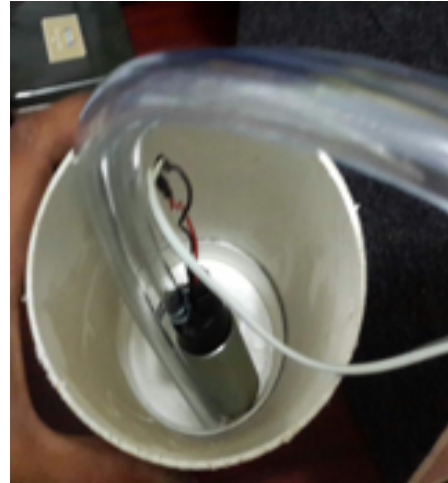
Figura 2. Bomba y reservorio de agua residual.
