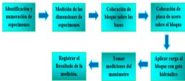
Figura 7. Diagrama de Procedimientos de ensayo de resistencia a la compresión de los bloques ecológicos.
