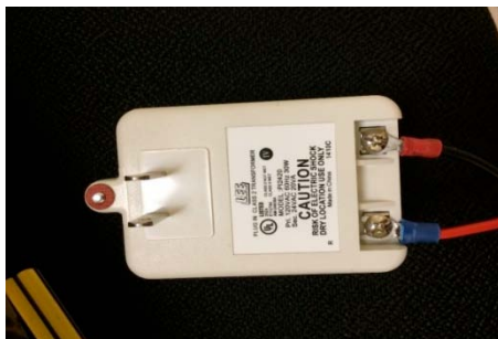
Figura 11. Transformador utilizado para alimentar la cerradura electrónica.
