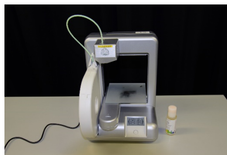
図 2 FDM 方式の 3D プリンター (3D Systems 社製の Cube)
