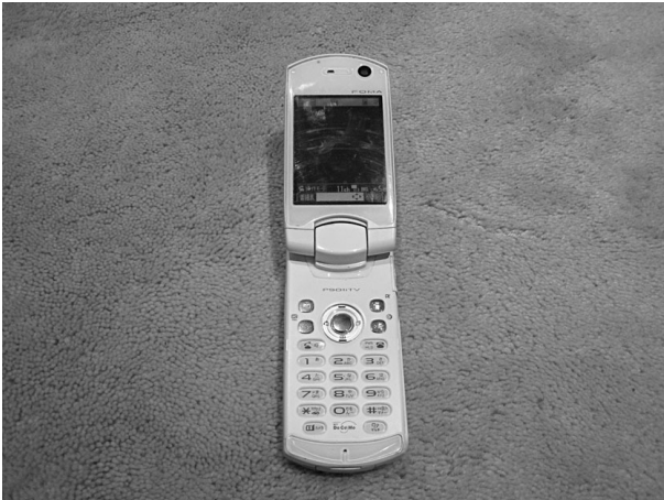
図4 ワンセグ受信機能つき携帯電話 (P901iTV、PANA-SONIC 社製)
