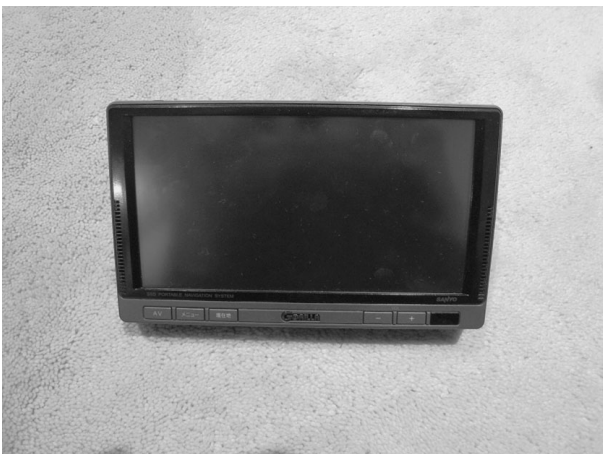
図6 ワンセグ受信機能つきカー・ナビゲーション (NV-SD700DT、サンヨー社製)
