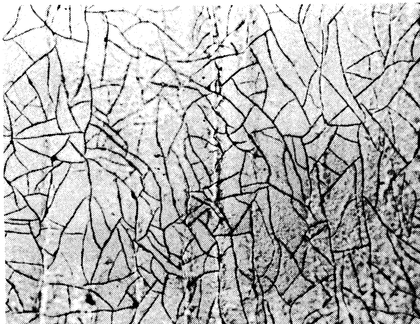
写真6 クロメート皮膜クラック障害の顕微鏡写真 (光学顕微鏡×400)
