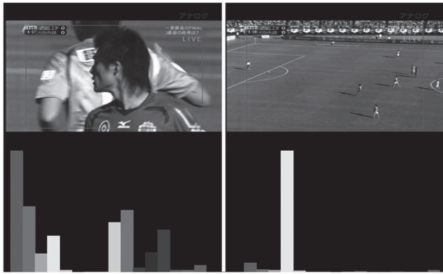
図6 1秒間隔の2枚のフレーム画像(上)とその色ヒストグラムの計算結果(下)
