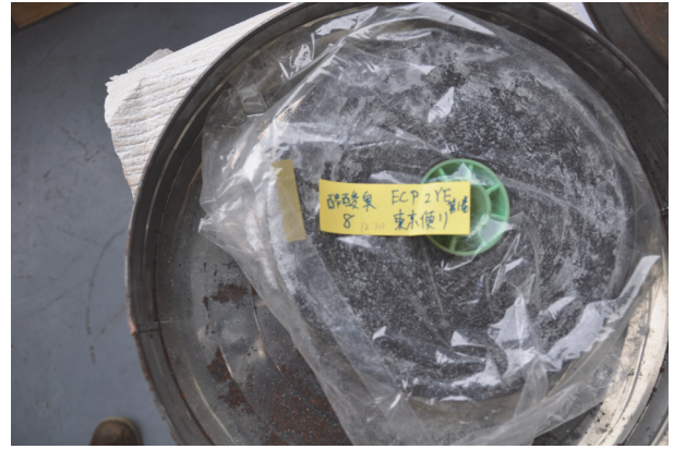
Figure 4a. 劣化の著しいフィルム；白色固体・変形
