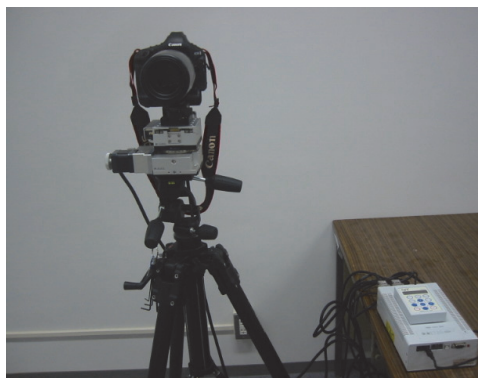
図6 製作したパノラマ写真自動撮影装置 カメラと三脚の間にあるのが2台の回転ステージで、テーブルの上にあるのがコントローラー
