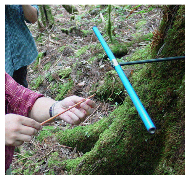
成長錘で木に穴を開けてサンプルを採取
