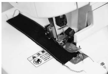
写真14 ロックミシンで布の裁断と布端の処理
