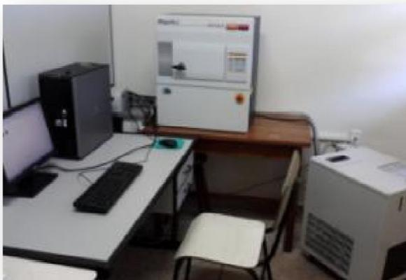
**Figura 5:** Difratorômetro de raios X, Mini Flex II, do LABMAT. UNIFAP
