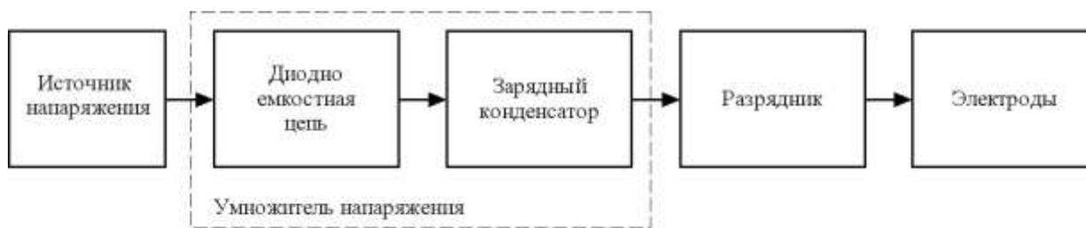
Рис. 1. Блок-схема установки для получения электрогидравлического эффекта
