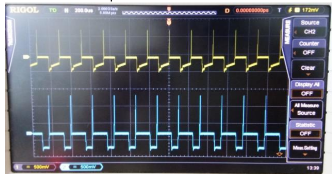
Gambar 11. Keluaran Sinyal dari Switching MOSFET.
