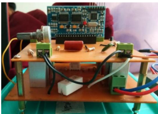
Gambar 8. Realisasi rangkaian pada PCB untuk implementasi SPWM.
