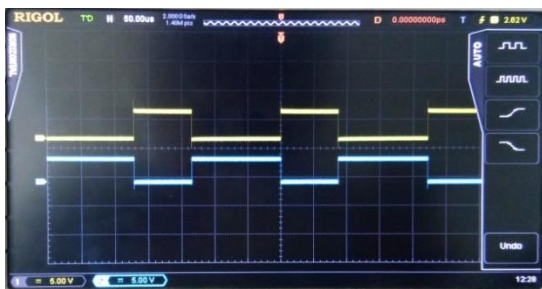
Gambar 9. Keluaran Sinyal PWM dari Arduino.
