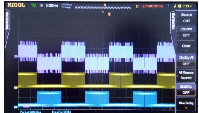
Gambar 13. Bentuk sinyal SPWM dan keluaran driver SPWM.
