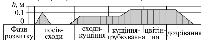
Рис. 2. Схема реалізації ресурсоощадного режиму зрошення в разі поверхневого затоплення за фазами розвитку рису
