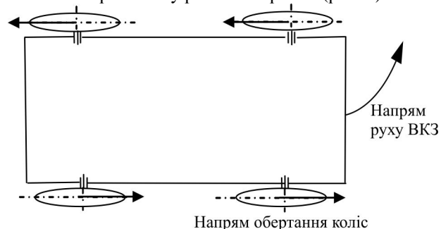
Рис. 2. Схема виконання повороту ВАТ "по-гусеничному"
