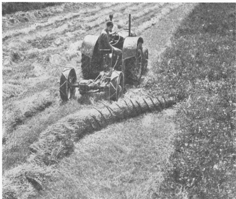
Fig. 3. Med Skaarrulleren rømmes fri Bane for Traktoren.
