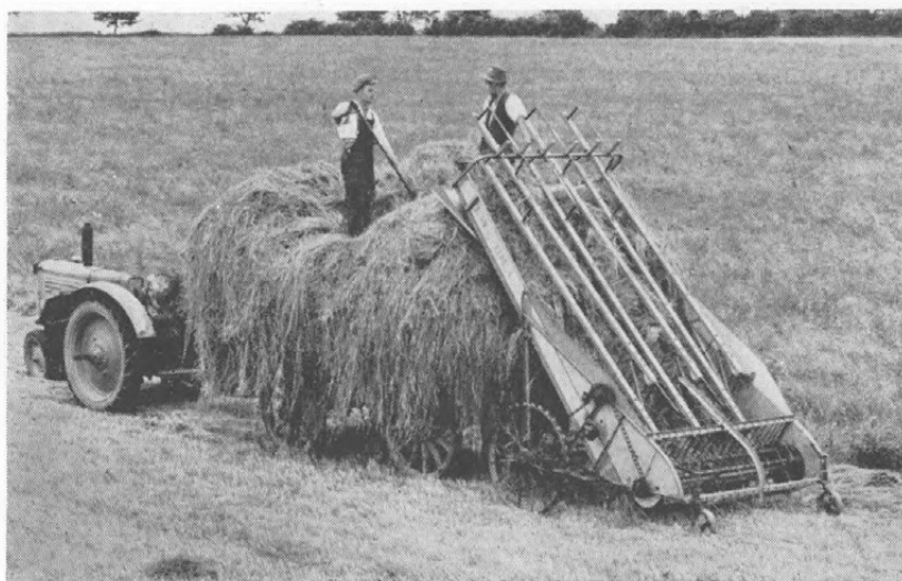
Fig. 4. Grøntlæsser koblet efter Vogn.
