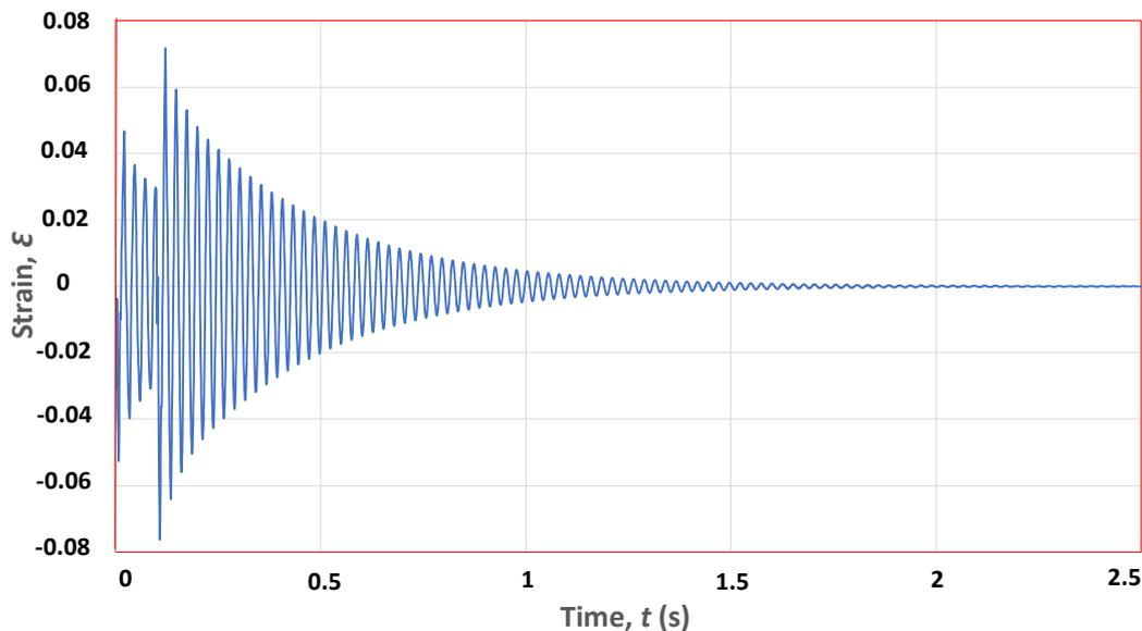
**Gambar 8.** *Time history response* pada robot manipulator
