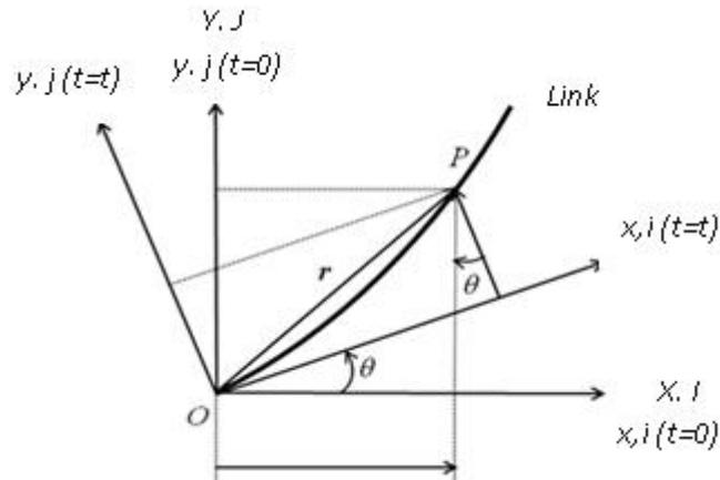
**Gambar 2.** Arah gerak rotasi pada *single-link* manipulator
