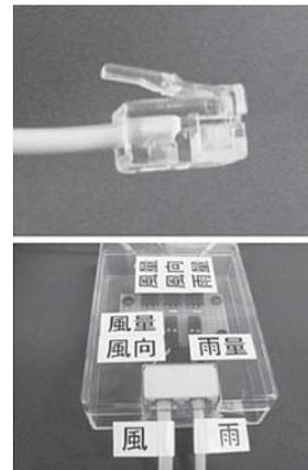
図9 センサーとコネクタ変換基板を接続 (上：モジュラーjack、下：コネクタ変換基板に接続)
