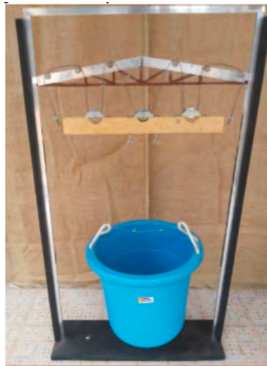
Figura 1. Protótipo para realização da quebra das treliças.
