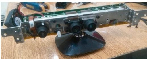
Figura 10: Kinect parcialmente desmontado.
