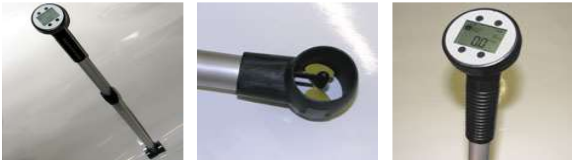
Figura 7. Medidor de flujo Global Water Flow Probe modelo FP211 Fuente http://www.globalw.com
