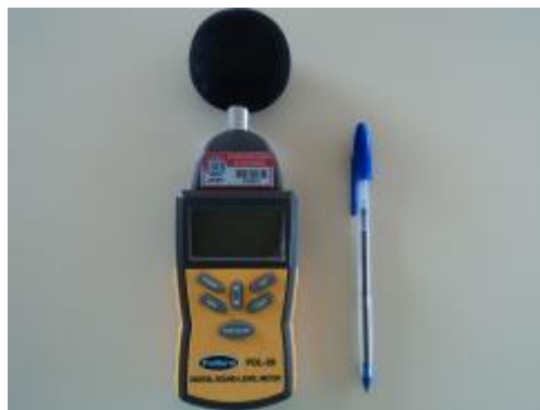
Figura 2 – Equipamento decibelímetro Fonte: Romário Rosa de Sousa (2015).
