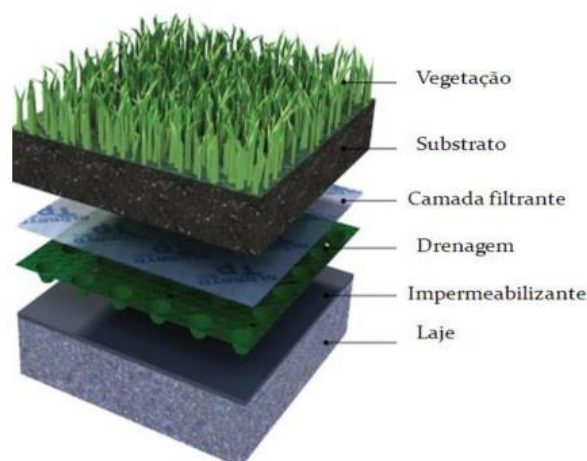
Figura 2 – Corte esquemático do telhado verde com seus componentes.
