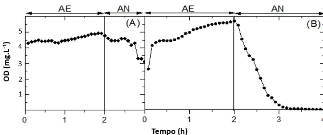
**Fig. 1 - Concentração de OD durante um ciclo de aeração intermitente: ciclo I – 2h AE/1 h AN(A) e ciclo II – 2h AE/2h AN (B)**
