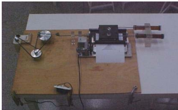
Figura 5. Apresentação do sistema completo, com o oscilador e registrador x-t ao centro e tendo à esquerda o propulsor externo para estudo de oscilações sob ação de forças externas, e à direita, os dois amortecedores cilíndricos associados em paralelo para estudo de amortecimento monitorado.
