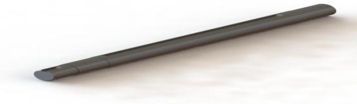
**Figura. 2. Modelo del árbol del molino triturador (SolidWorks 2014).**
