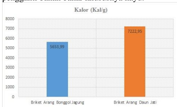
Gambar 5. Grafik Nilai Kalor Briket Arang Bonggol Jagung dan Briket Arang Daun Jati
