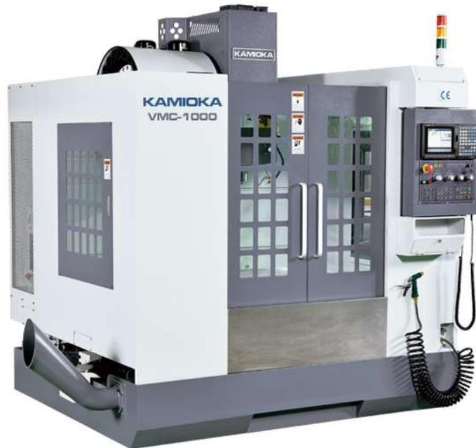
**Gambar 3.1 Mesin CNC Kamioka VMC-1000**
