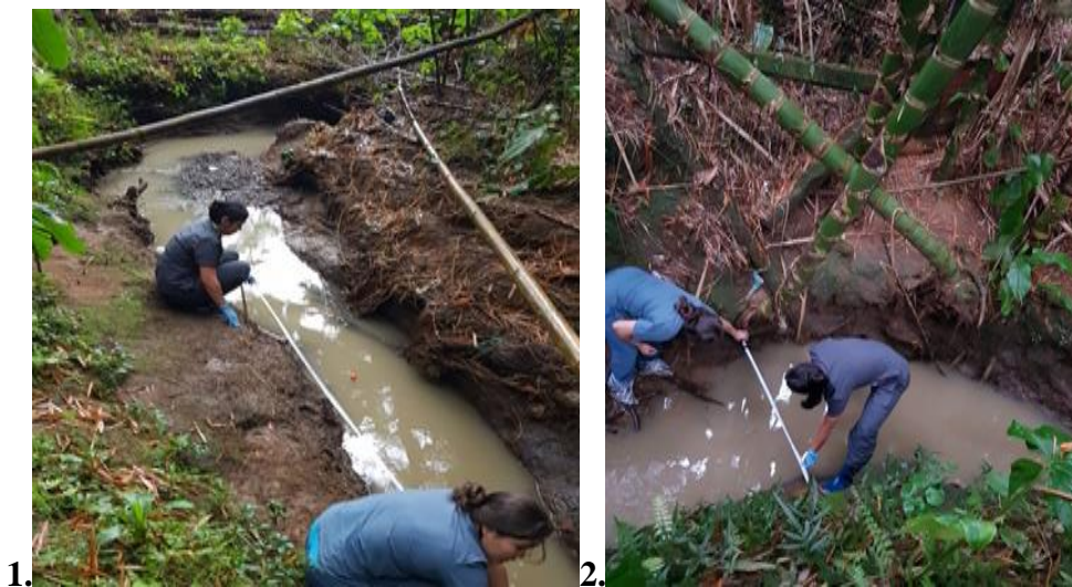
Figura 1 y 2. Método del flotador para medición del caudal. Campus Universidad Libre Pereira Sede Belmonte 2018.
