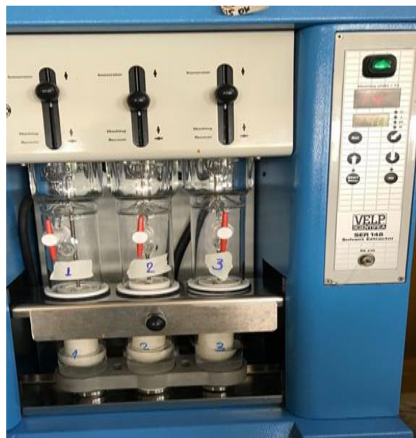
Figura 23: Extracción método soxhlet. Laboratorio Universidad Libre Seccional Pereira 2018.
