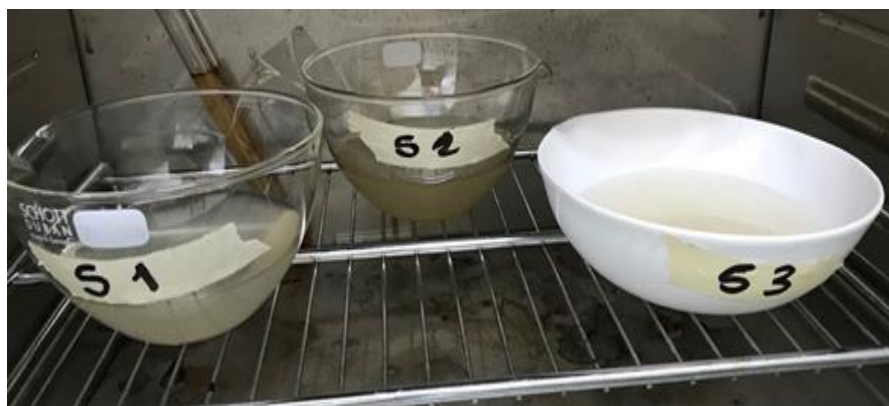
Figura 19: Cápsulas en el horno en una temperatura de 105°C. Laboratorio Universidad Libre Seccional Pereira 2018.
