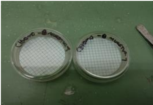
Figura 6. Membranas dispuestas en agar chromocult para ser incubadas. Laboratorio Universidad Libre Pereira Sede Belmonte 2018.
