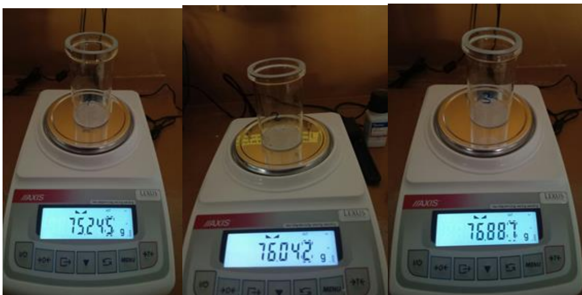
Figura 24: Peso final de grasas de la muestra 1, 2, 3 en una balanza analítica. Laboratorio Universidad Libre Seccional Pereira 2018.
