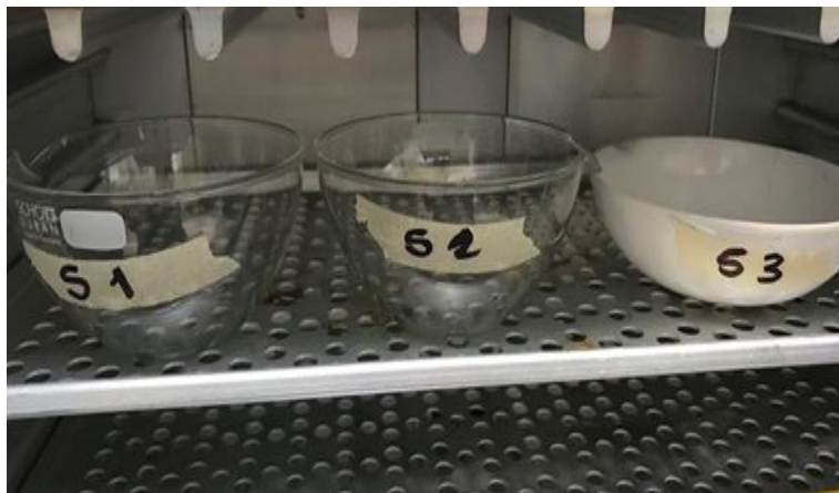
Figura 17: Peso seco de las cápsulas en el Horno. Laboratorio Universidad Libre Seccional Pereira 2018.
