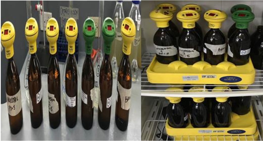
Figura 16: Frascos con sus respectivas muestras con su oxitop. Laboratorio Universidad Tecnológica de Pereira 2018.
