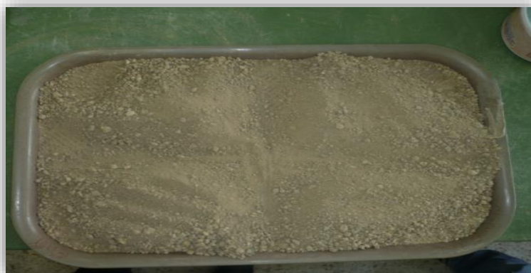
Figura 20. Muestra secada y lista para ser sometida a los ensayos.
