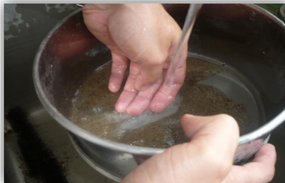
Figura 26. Proceso de lavado de la muestra en el tamiz # 200.
