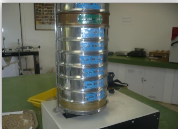
Figura 22. Muestra sometida al ensayo de tamizado.
