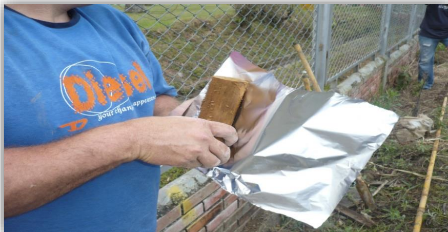
Figura 24. Embalaje de la muestra inalterada para ser llevada al laboratorio
