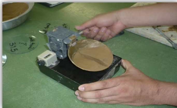
Figura 21. Muestra sometida al ensayo de casa grande.
