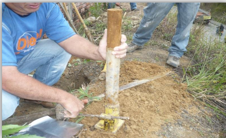
Figura 23. Obtención de las muestras inalteradas.
