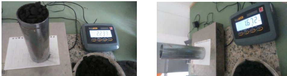
Figura 13. Peso tubo para densidad con carbón y peso tubo para densidad.
