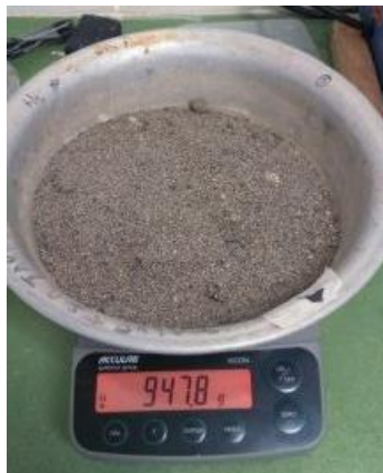
Figura 22. Peso Agregado Fino para tamizado.
