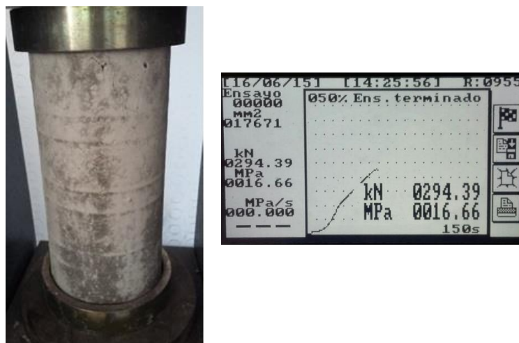
Figura 114. Falla de cilindro con carbón mineral 1%, Fondo (14 días).
