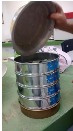
Figura 17. Tamizado Agregado grueso y agregado grueso.
