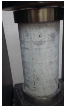
Figura 87. Cilindro con falla de 1/2\" 3% a los 14 días.
