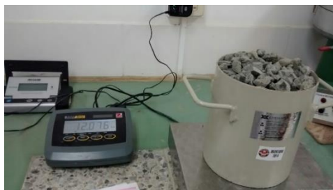
Figura 28. Peso Agregado Grueso Compactado y agregado Grueso.
