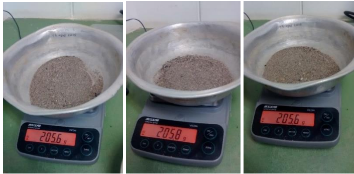
Figura 39. Lectura final agregado fino secado en el horno.
