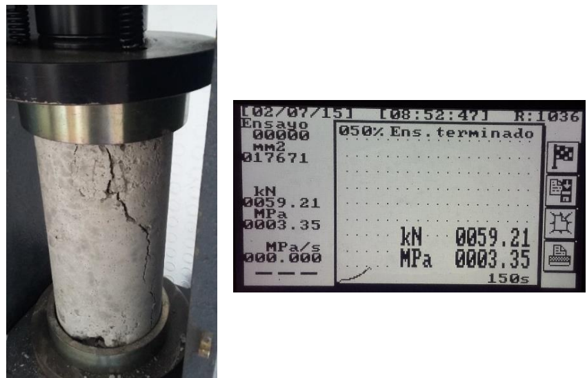
Figura 134. Falla de cilindro con carbón mineral 5%, Fondo (28 días).
