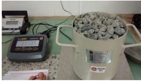
Figura 27. Peso Agregado Grueso Suelto.
