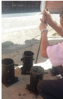
Figura 58. Vibración de la mezcla en moldes.
