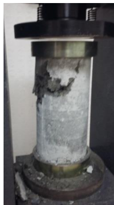
Figura 88. Cilindro con falla de 1/2\" 5% a los 14 días.
