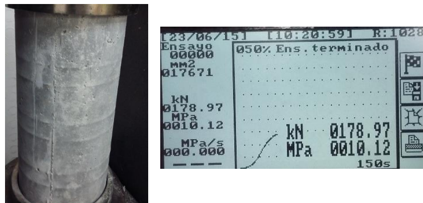
Figura 124. Falla de cilindro con carbón mineral 3%, Fondo (21 días).
