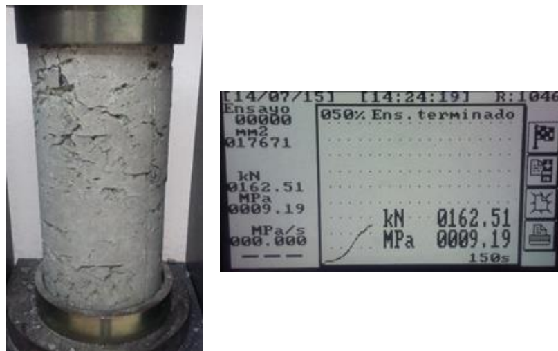
Figura 136. Falla de cilindro con carbón mineral 5%, 3/8" (21 días).
