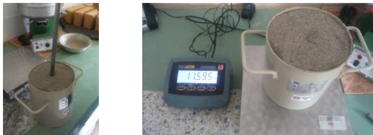
Figura 30. Agregado Fino compactado y peso Agregado Fino compactado.
