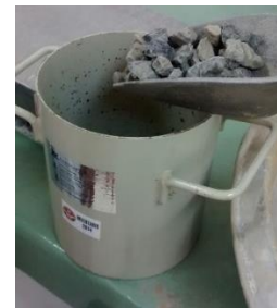
Figura 28. Peso Agregado Grueso Compactado y agregado Grueso.
