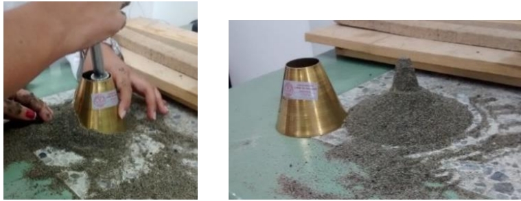
Figura 34. Ensayo molde cónico no hay humedad libre.
