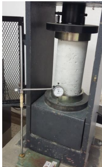
Figura 89. Ensayo de tensión para cilindro de concreto.
