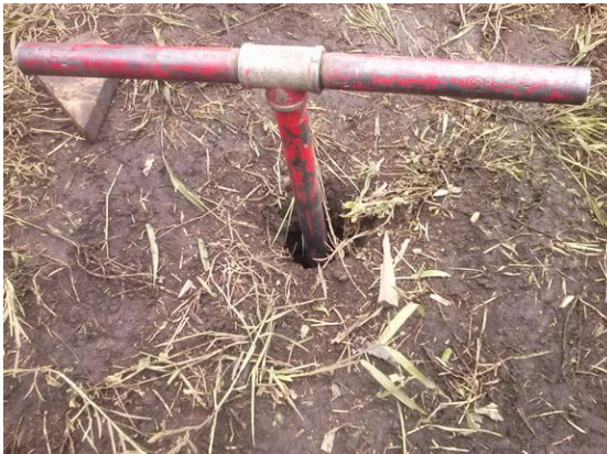
Figura 23. Extracción de muestra de suelo con tubo shelby, utilizando un tornillo sin fin para así llegar a una mayor profundidad
