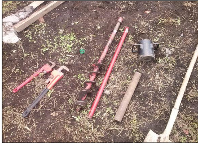
Figura 22. Instrumentos utilizados para extracción de muestra de suelo con tubo shelby
