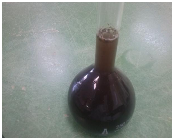
Figura 36. Pícnómetro con muestra de suelo para ensayo de gravedad específica Combia
