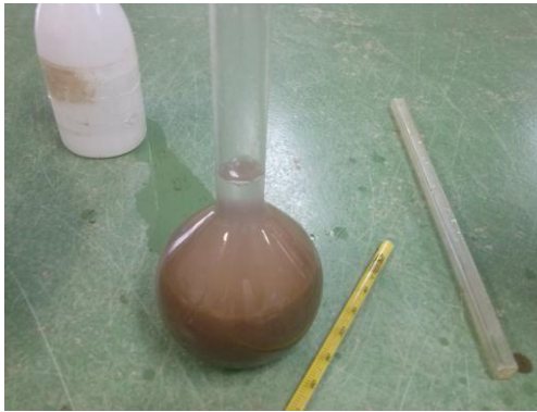
Figura 34. Pícnómetro con muestra de suelo para ensayo de gravedad específica Milán
