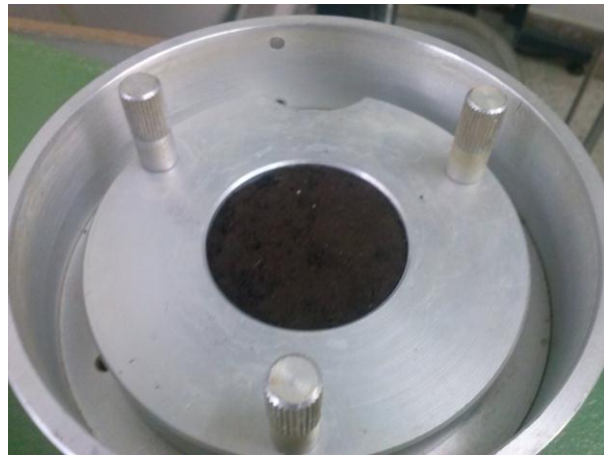
Figura 41. Muestra lista para ensayo de consolidación Combia
