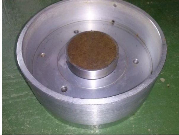
Figura 40. Muestra lista para ensayo de consolidación Milán
