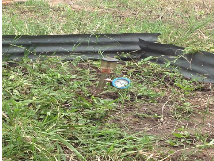
Figura 19. Piezómetro, ubicado en Combia (Pereira). Fuente: Trabajo de campo
