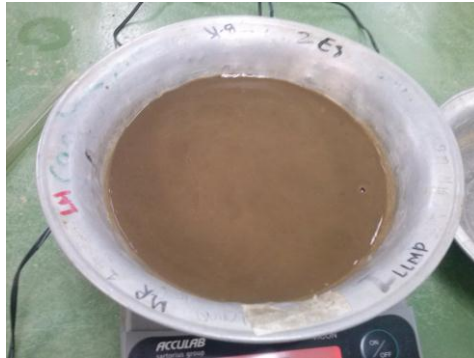
Figura 35. Muestra lista para el horno para ensayo de gravedad específica Milan
