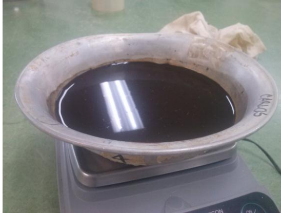
Figura 37. Muestra lista para el horno para ensayo de gravedad específica Combia
