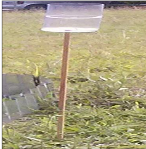
Figura 17. Pluviómetro Milán (Dosquebradas) diámetro=15 cm, volumen=4400 ml. Fuente: Trabajo de campo
