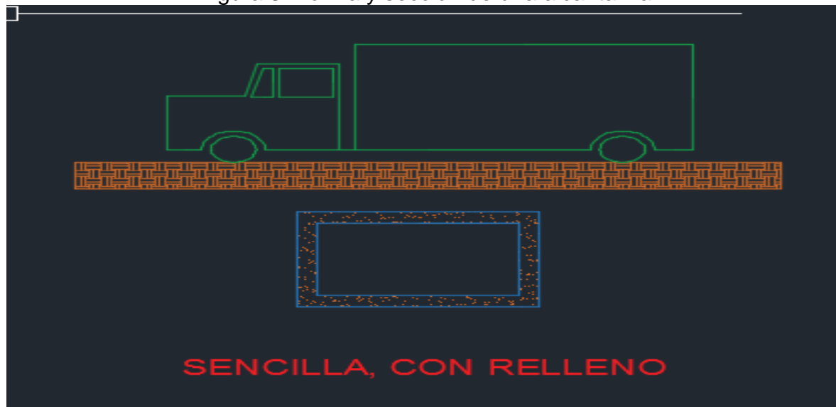
Figura 8. Forma y sección de una alcantarilla
