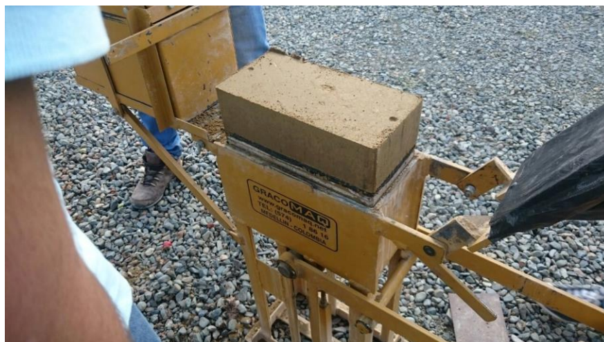
Figura 16. BTC una vez realizada la compactación.
