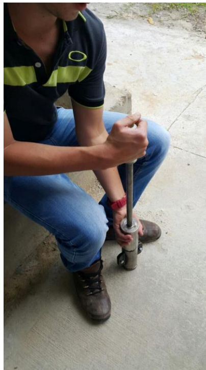
Figura 10. Realización de probetas de suelo-cemento.
