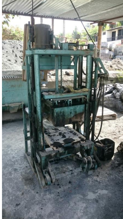
Figura 13. Máquina para realizar adoquines y losetas
