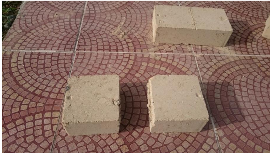
Figura 18. Fraccionamiento de los bloques para la construcción de los muretes.
