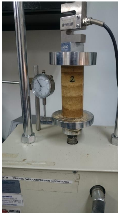
Figura 11. Ensayo a la compresión no confinada de las probetas de suelo-cemento.
