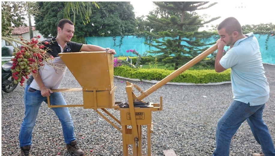
Figura 15. Realización de los BTC en la Cinva Ram.
