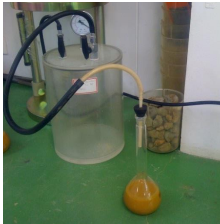
Imagen 09. Ejecución del ensayo de gravedad específica Fuente propia
