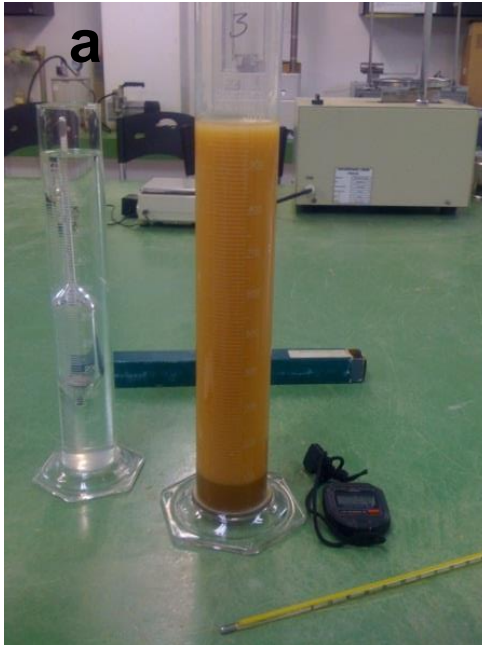
Imagen 12. Ensayo del hidrómetro a) Suelo con solución para dispersión de partículas. Fuente propia
