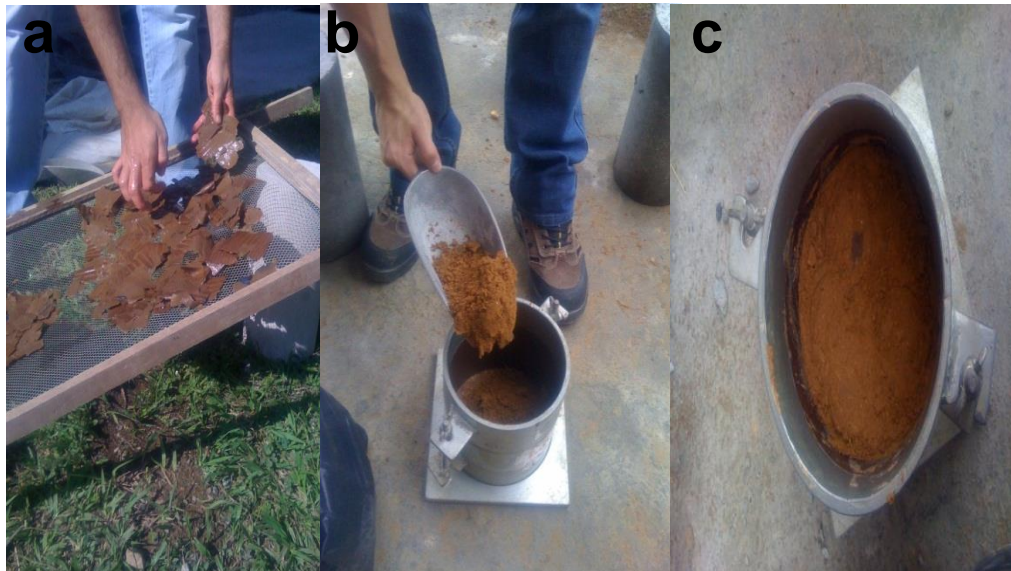
Imagen 14. Ensayo de Proctor Modificado con cartón y cal. a) Eliminación de exceso de agua de cartón. b) Mezcla de suelo, cartón y cal. c) Primera capa compactada después de 25 golpes. Fuente propia
