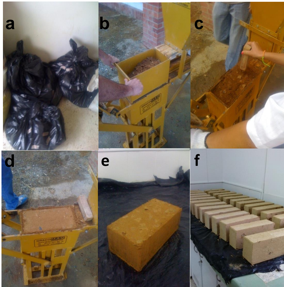
Imagen 16. Fabricación de bloques de tierra comprimida a) Mezcla para elaboración de BTC. b) Elaboración de BTC fase1. c) Elaboración de BTC fase 2. d) Elaboración de BTC fase 3. e) BTC terminados sin ser secados. f) BTC terminados completamente secos. Fuente propia
