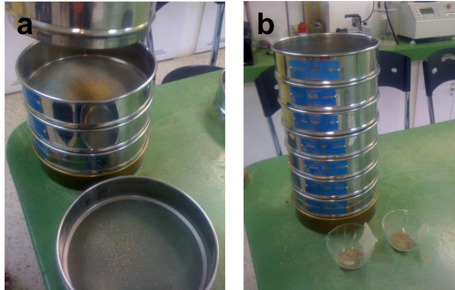
Imagen 11. Ensayo de granulometría a) Preparación ensayo granulometría. b) Material que retiene el tamiz. Fuente propia
