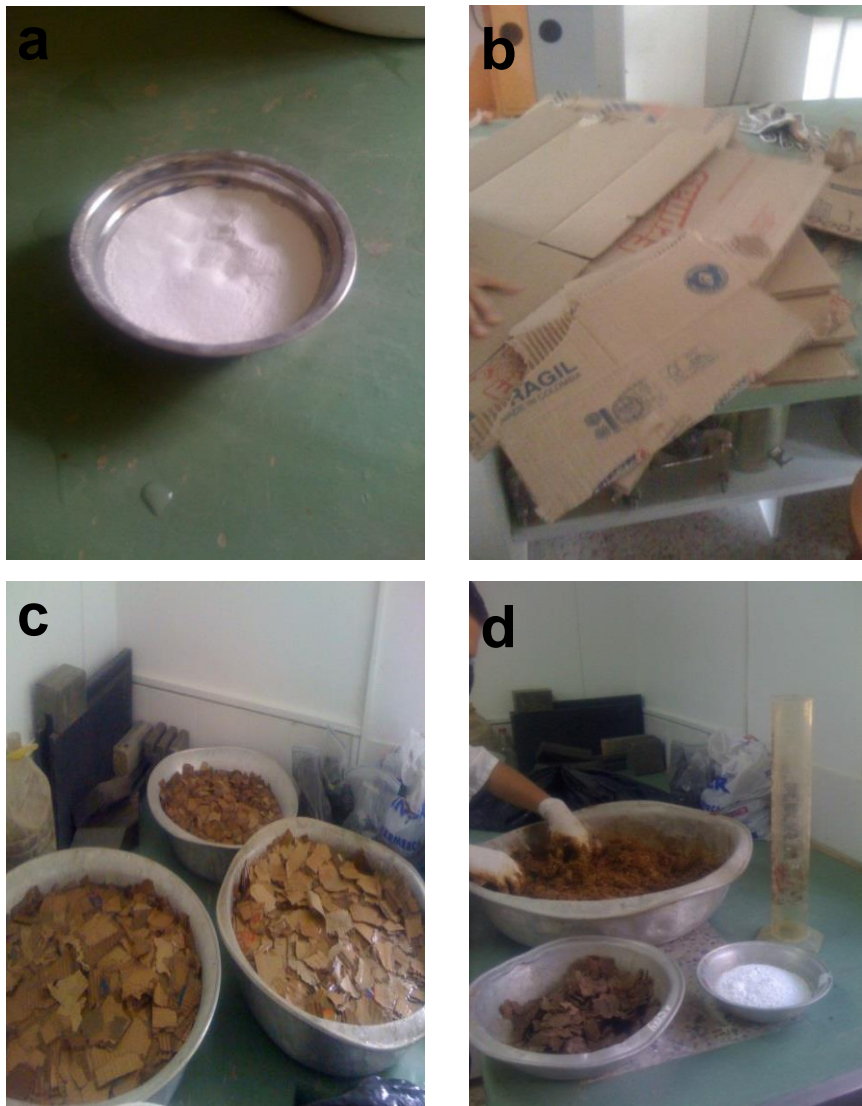
Imagen 15. Preparación de materiales para la elaboración de los BTC a) Cal. b) Cartón. c) Cartón en proceso de remojo. d) Preparación de la mezcla para los adobes. Fuente propia
