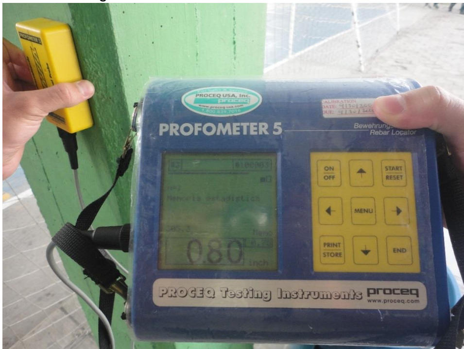
Figura 3. Toma de medidas con Ferroskan.
