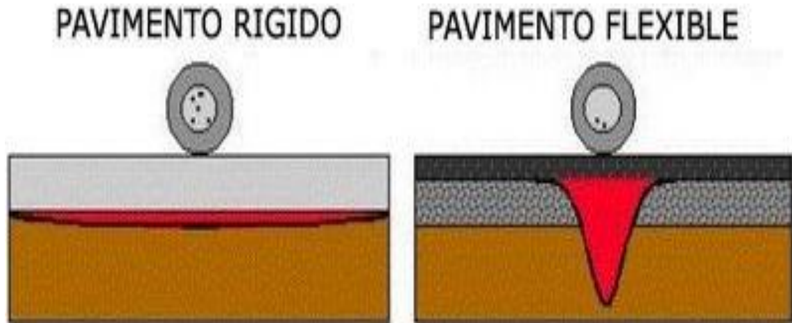
Figura 2. Distribución de cargas de pavimento rígido y flexible.
