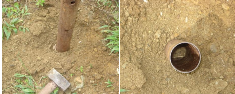
Figura 126 y 127. Muestra con tubo Shelby
