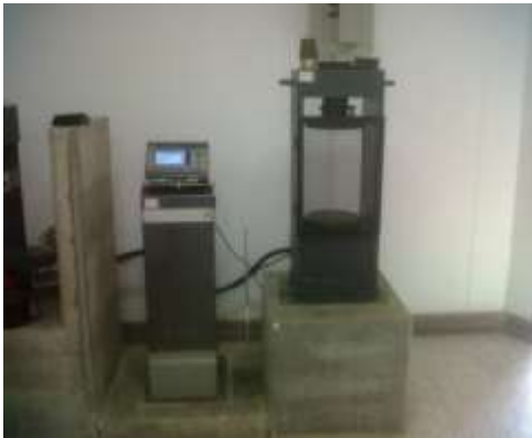
Figura 4. Máquina de ensayos de compresión
