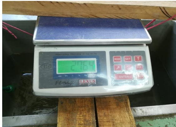
Figura 49. Peso del montaje más la masa sumergida. Fuente: Elaboración propia.
