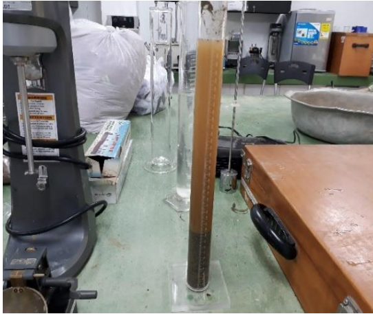
Figura 45. Ensayo equivalente de arena. Fuente: Elaboración propia
