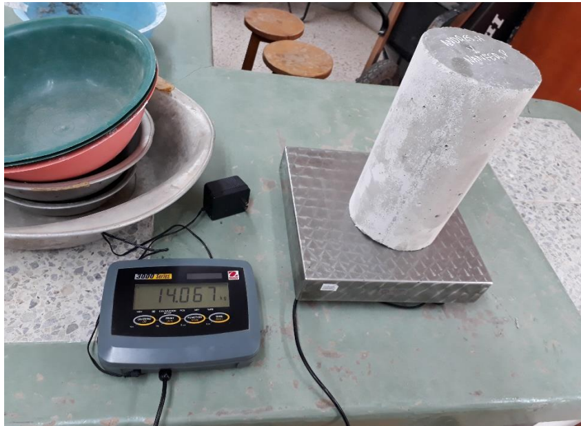
Figura 62. Peso del cilindro. Fuente: Elaboración propia.
