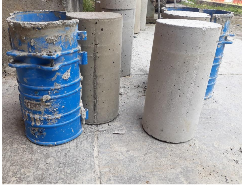
Figura 60. Desencofre de cilindros. Fuente: Elaboración propia.
