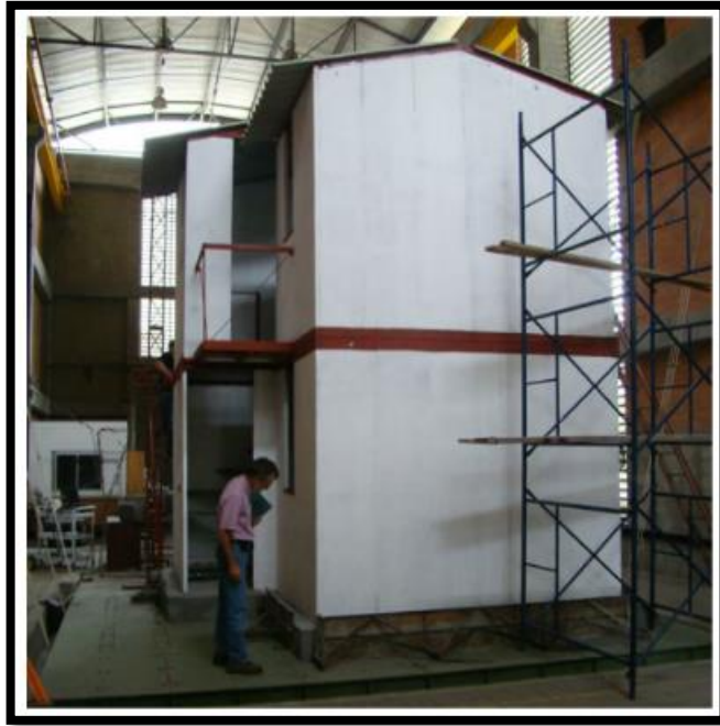
Figura 11 Mesa de Simulación Sísmica Universidad Eafit.
