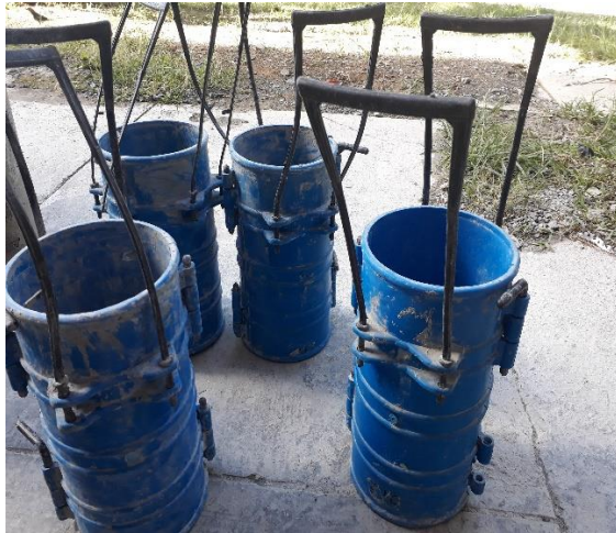
Figura 56. Moldes para la elaboración de los cilindros. Fuente: Elaboración propia.
