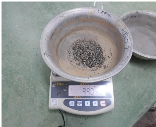
Figura 54. Masa seca al horno extraída del picnómetro. Fuente: Elaboración propia
