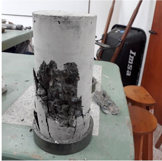
Figura 66. Ruptura del cilindro a los 28 días. Fuente: Elaboración propia.
