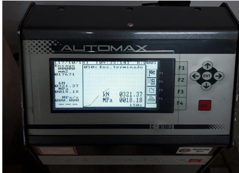
Figura 63. Resultado de la ruptura del cilindro a los 21 días. Fuente: Elaboración propia.
