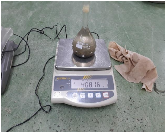
Figura 53. Peso picnómetro con agua más la muestra. Fuente: Elaboración propia.
