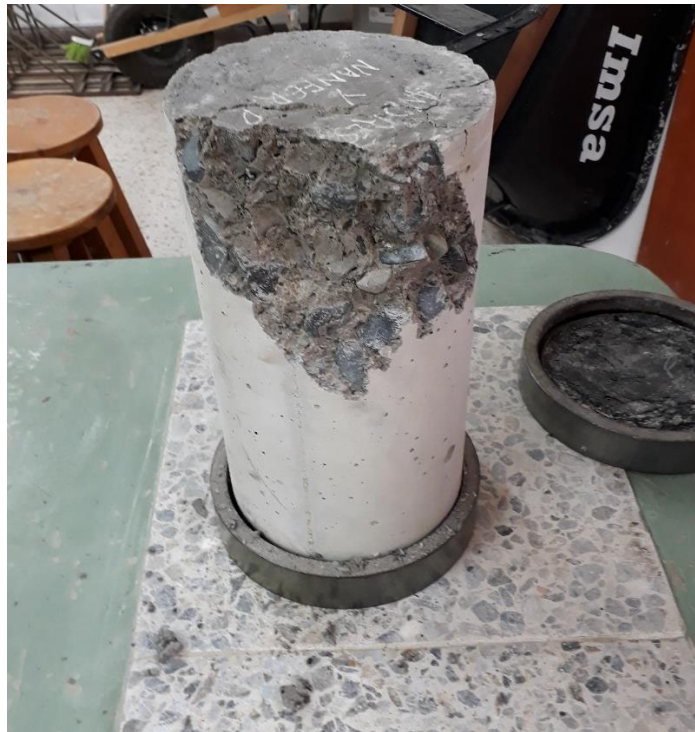
Figura 64. Ruptura del cilindro a los 21 días. Fuente: Elaboración propia.
