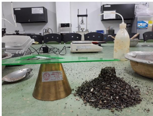
Figura 51. Comprobación del estado saturado. Fuente: Elaboración propia
