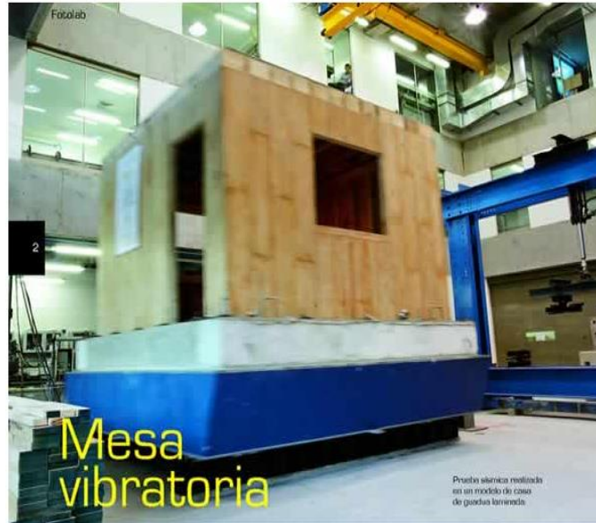
Figura 10 Mesa de Simulación Sísmica Universidad de los Andes. Fuente: Revista Contacto, Universidad de los Andes.
