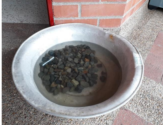
Figura 47. Material sumergido en agua. Fuente: Elaboración propia.
