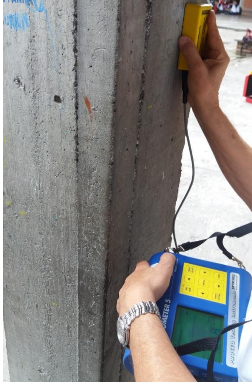
Figura 26. Prueba en columna con ferroskan. Fuente Propia
