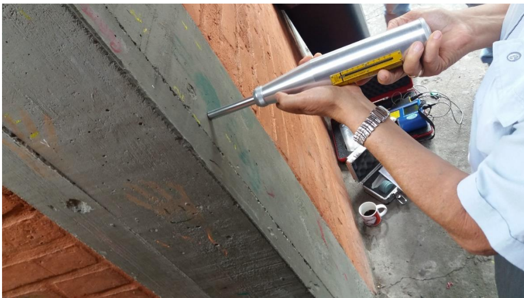
Figura 27. Prueba en columna con esclerómetro Fuente Propia
