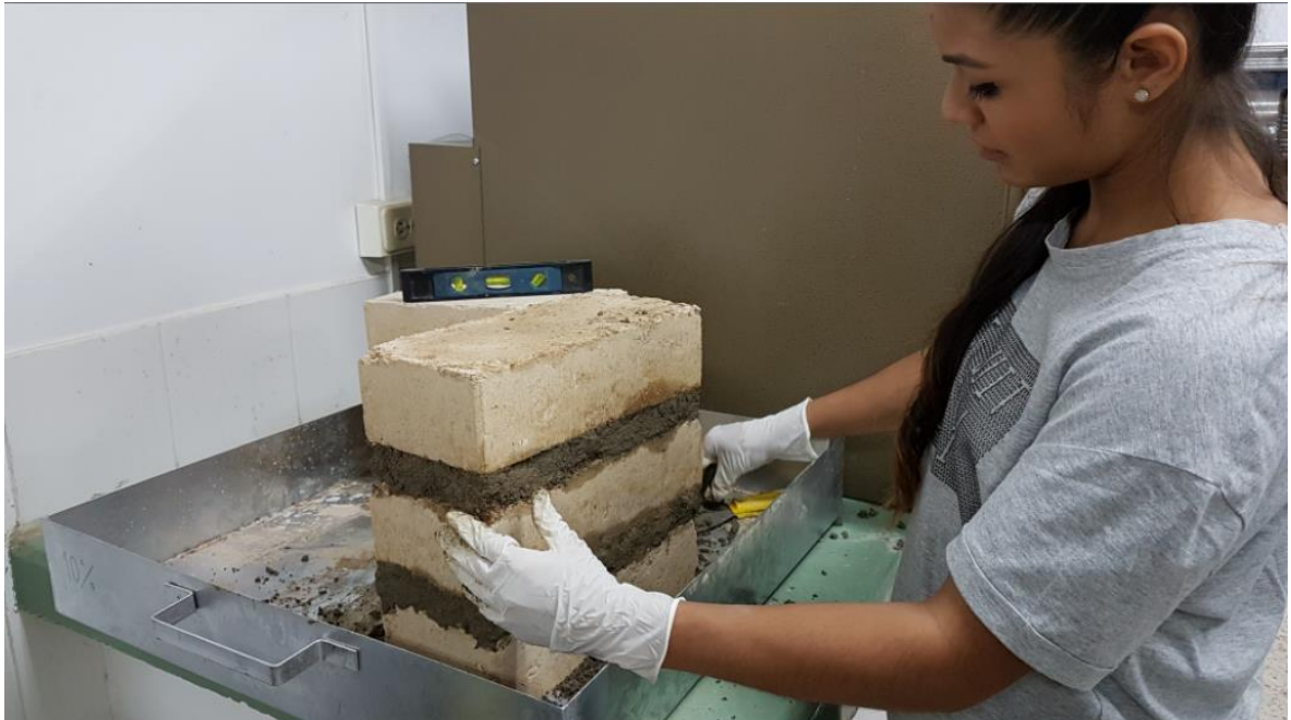
Figura 6. Elaboración del murete
