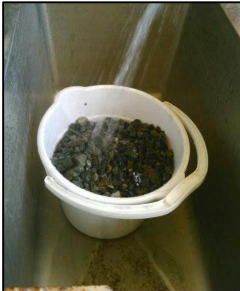
Figura 8. Muestra sumergida en agua 24 horas
