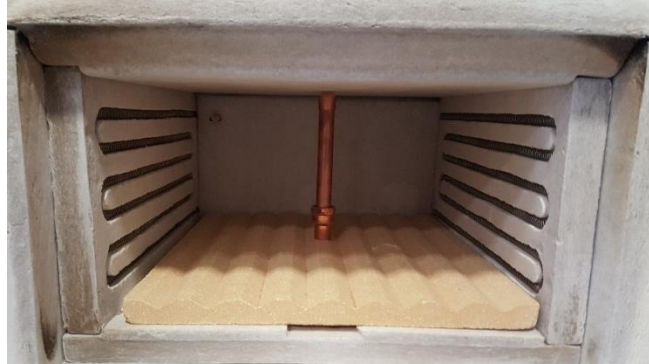
Figura 26. Ubicacion del molde dentro de la muffla
