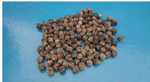
Figura 34. Paso 7 Elaboracion en masa del material de estudio (Pellet)
