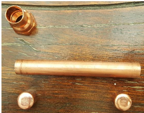
Figura 23. Molde de cobre con tapas
