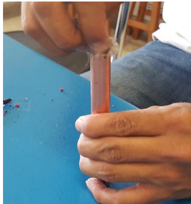
Figura 25. Compactación de material dentro del molde
