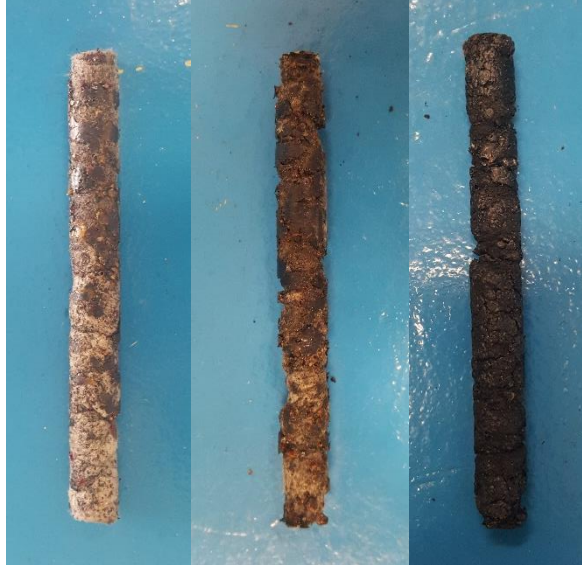
Figura 29. Muestra fundidas a 300°C, 330°C y 400°C
