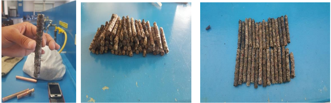
Figura 33. Paso 7 Elaboracion en masa del material de estudio (Pellet)
