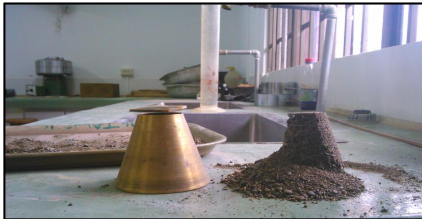
Figura 11. Ensayo molde cónico no hay humedad libre
