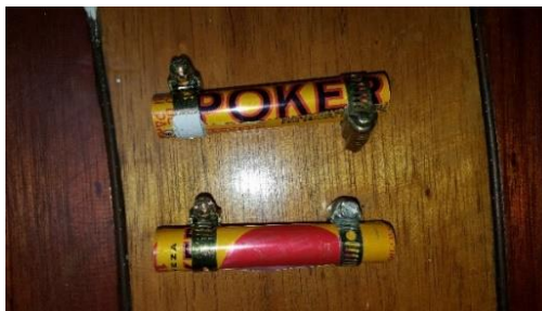
Figura 21. Moldes de aleación de aluminio creados con latas de cerveza
