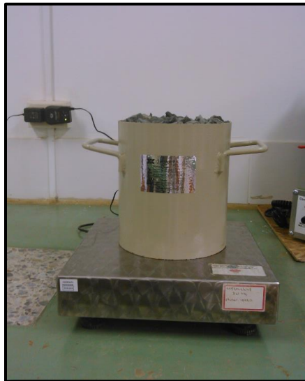
Figura 7. Molde con grava
