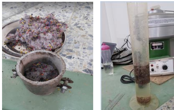
Figura 15. Ensayo de densidad con el método de peso/volumen (izquierda) y Arquímedes (derecha)
