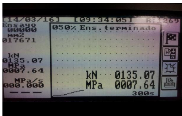
Figura 43. Resultado de esfuerzos de compresión cilindro 28 días al 5%
