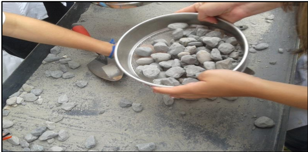
Figura 5. Tamizado material descargado
