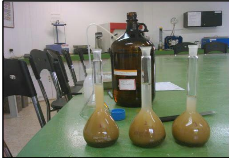
Figura 14. Picnómetros, muestra, agua
