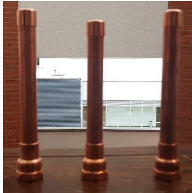
Figura 24. Moldes armados para la ubicación dentro de la muffla
