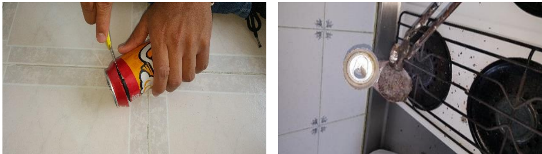
Figura 19. Ensayo de fundición del nylon con mayor cantidad de material
