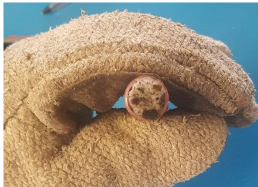
Figura 28. Extraccion de muestra fundida de nylon
