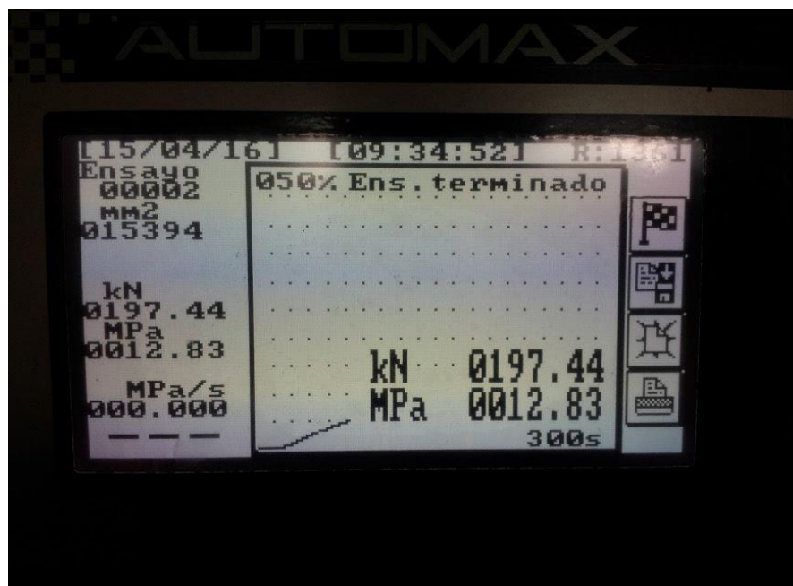
Figura 37. Resultado de esfuerzos de compresión cilindro 7 días al 5%
