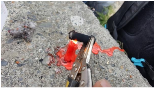
Figura 17. Procedimiento introducción de la muestra al molde
