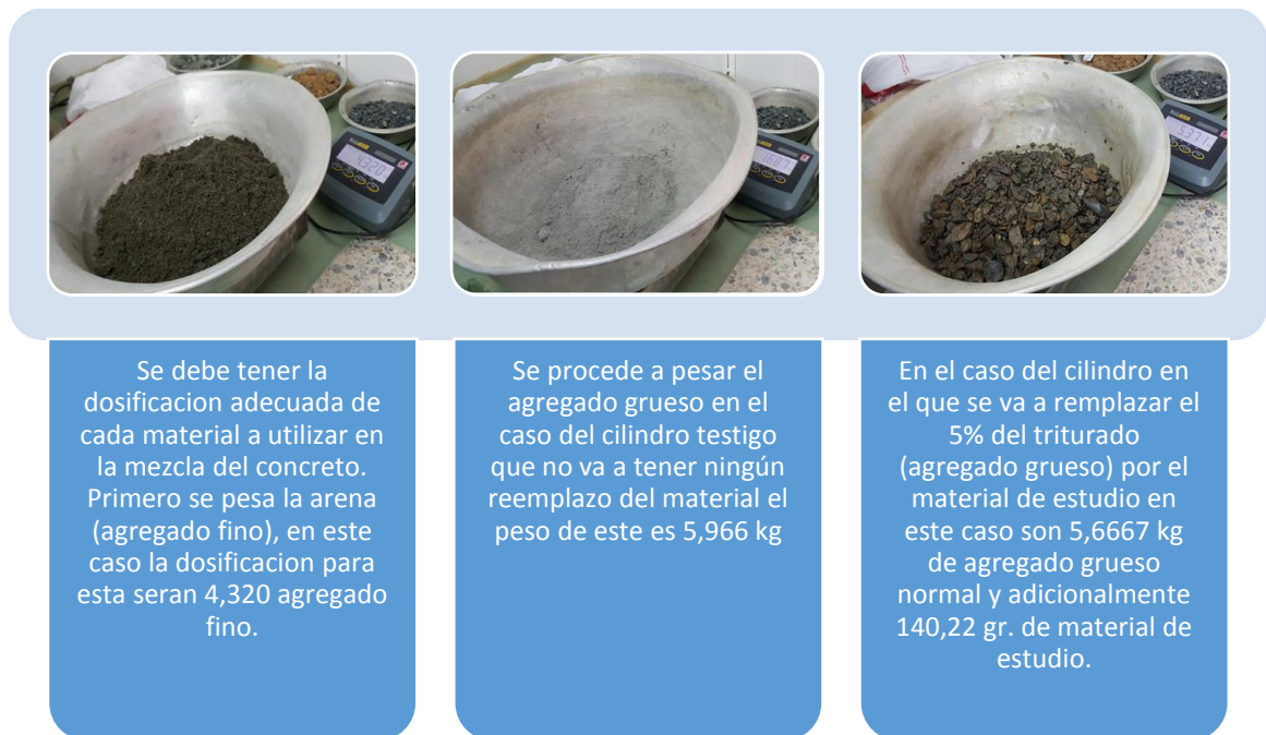
Figura 36. Proceso elaboración de cilindros de ensayo
