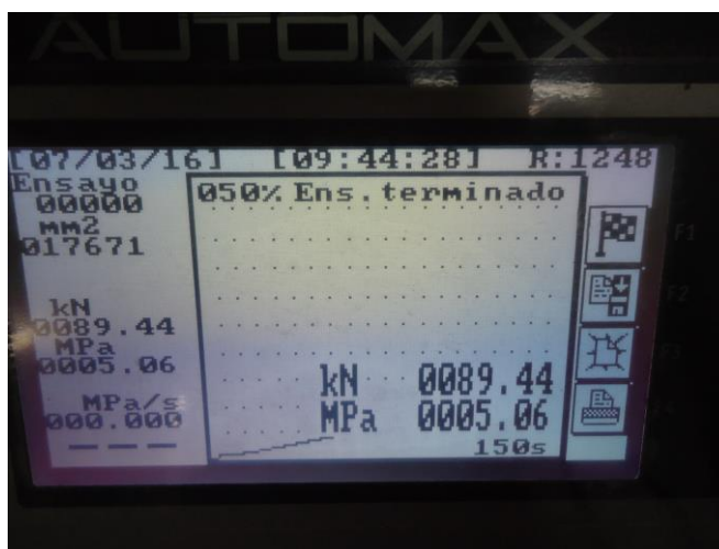
Figura 40. Resultado de esfuerzos de compresión cilindro 21 días al 10%
