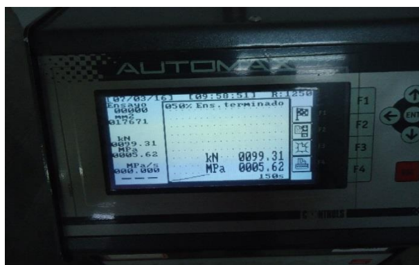
Figura 39. Resultado de esfuerzos de compresión cilindro 21 días al 5%
