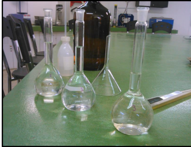
Figura 12. Picnómetros con agua
