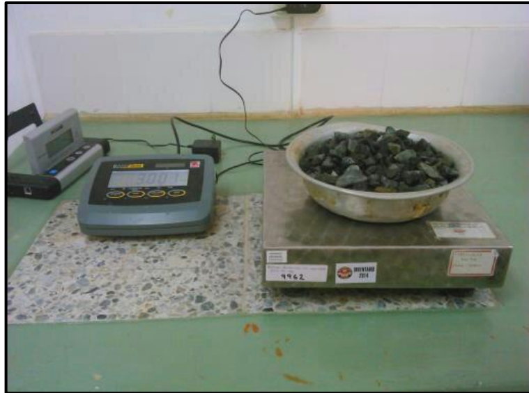
Figura 9. Peso muestra en estado saturado
