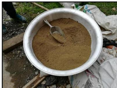
Material listo para prensado en la máquina Cinva Ram
