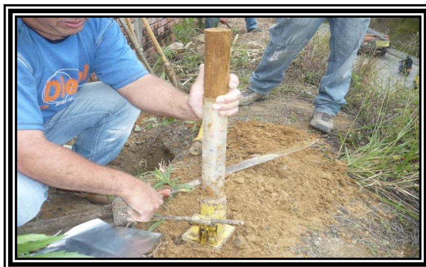
Figura 23. Obtención de las muestras inalteradas.
