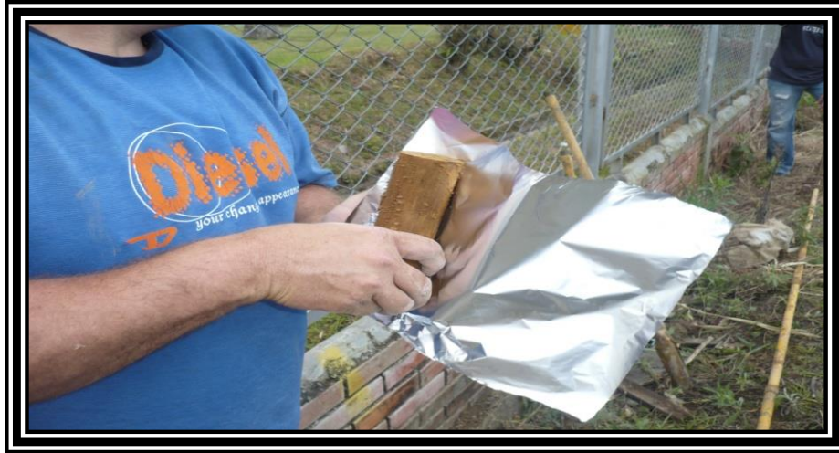
Figura 24. Embalaje de la muestra inalterada para ser llevada al laboratorio
