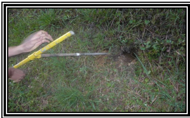
Figura 16. Proceso Mediante el cual se extrae la muestra inalterada
