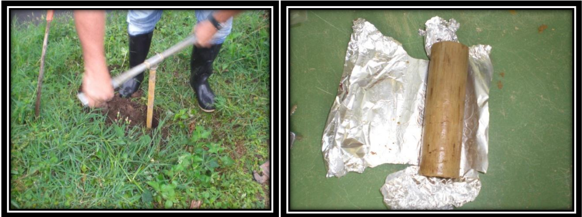
Figura 17. Fotografías Extracción de Espécimen Muestra Inalterada.
