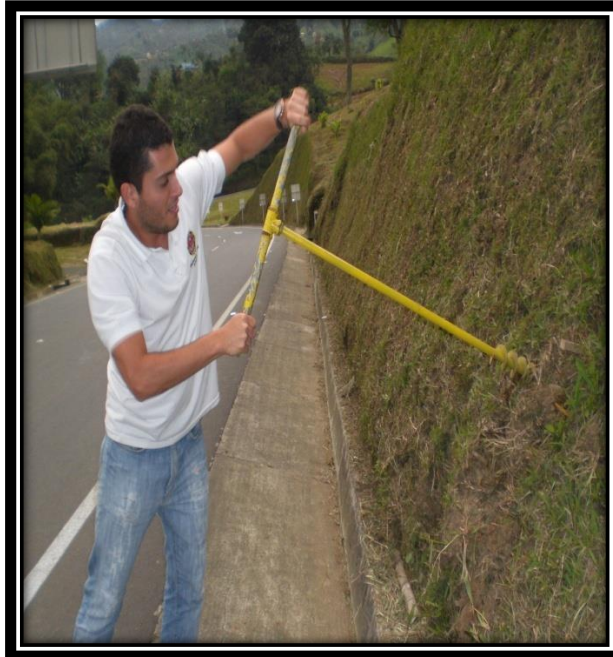
Figura 9. Proceso mediante el cual se extrae la muestra alterada.
