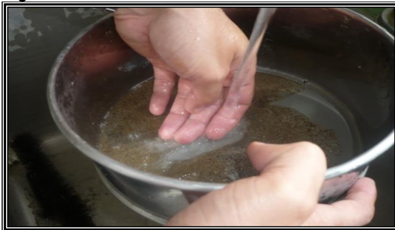
Figura 20. Lavado De La Muestra En El Tamiz # 200.
