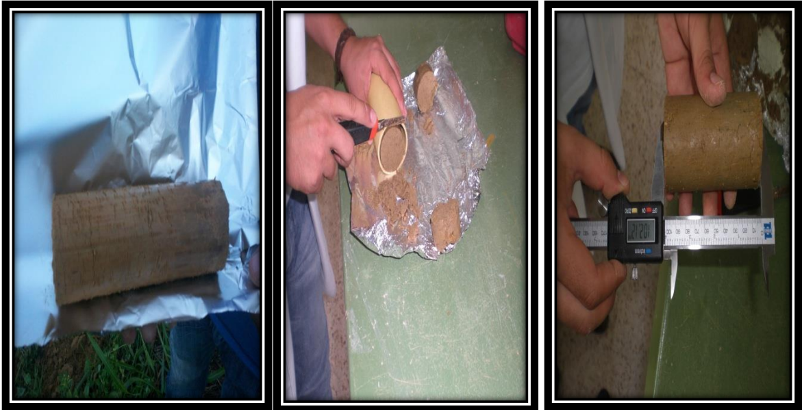
Figura 18. Fotografías Embalaje y Calibración De La Muestra Inalterada Para Ser Llevada Al Laboratorio.
