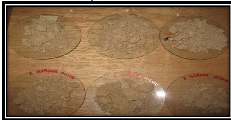
Figura 13. Muestras después de ser sacadas al horno 105°C.
